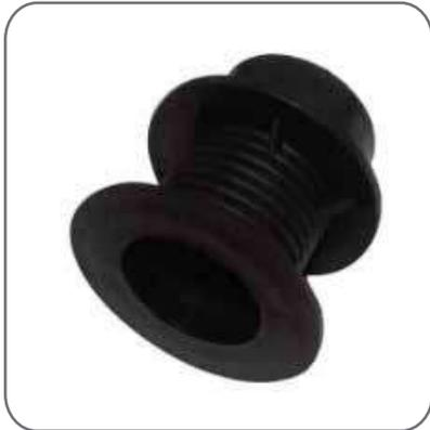
El obturador se utiliza como guía para atravesar la barra roscada, así se alinea el encofrado junto con el tubo PVC. Permite un sellado en ambas caras del encofrado, evitando derrames de concreto fresco durante el colado y/o vibrado sin necesidad de resane.
