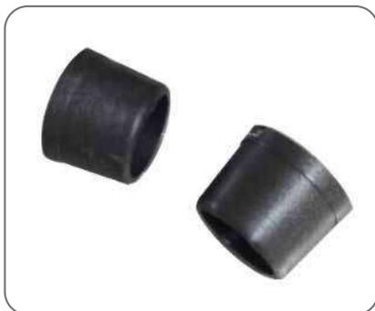
El tapón de plástico para encofrado sirve para colocar en el tubo de PVC después de retirar el cono distanciador de los muros. Si está trabajando con el obturador de estanquidad se inserta en el orificio del mismo. El tapón impide el pase de cualquier agente externo como agua o cualquier otro elemento.
